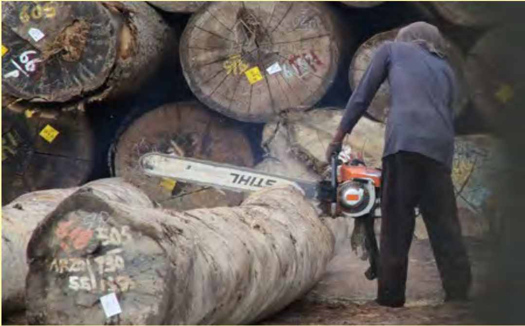
Gambar 26. Pekerja PT Alas Petala Tidak dilengkapi Alat Keselamatan Kerja
